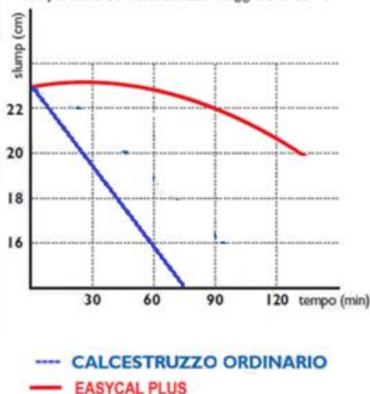
Perdita/mantenimento lavorabilità con temperatura del calcestruzzo maggiore di 28 °C
